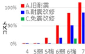
図11 震度階級と被害
