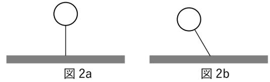
実験2: 図3aのように、水を入れた風船を水平な板上の固定器具に細い糸で固定し、ぶら下げた。風船が静止したのち、大きい加速度  $a$  が加わるような強い力で水平右方向に動かすと、風船は左方向に傾いた(図3b)。
